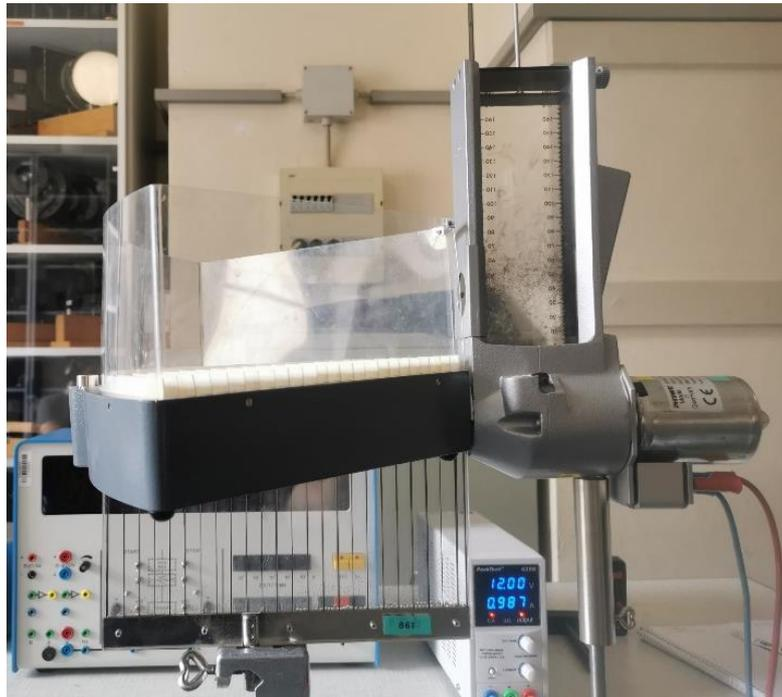
Abbildung 3: Foto des Versuchsaufbaus zur Darstellung Geschwindigkeitsverteilung
