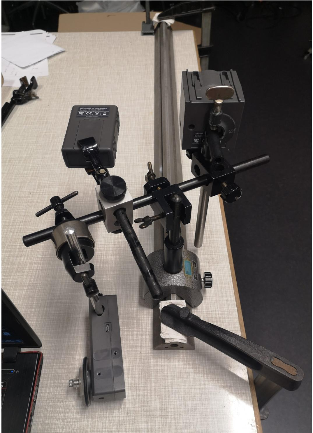
Abb. A.4: Foto des Aufbaus zur Intensität einer Lichtquelle mit den Sensoren von Vernier.
