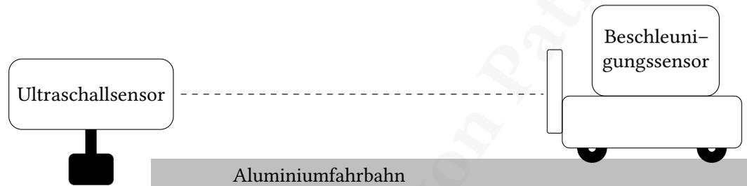
**Abb. 3.22:** Skizze des Versuchsaufbaus zur Bewegung eines Wagens auf einer Aluminiumfahrbahn. Ein Foto des Aufbaus befindet sich im Anhang: [Abb. A.7](#).
