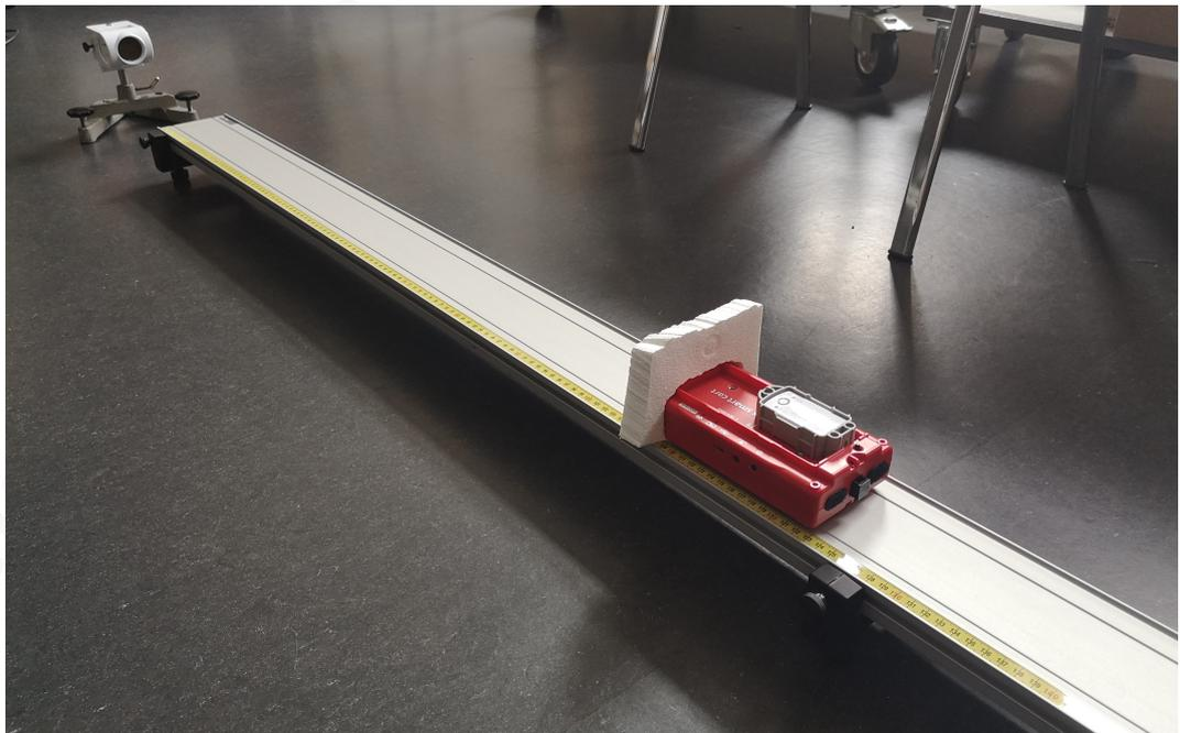
Abb. A.7: Foto des Aufbaus zur Bewegung eines Wagens auf einer Aluminiumbahn mit den Sensoren von Pasco.
