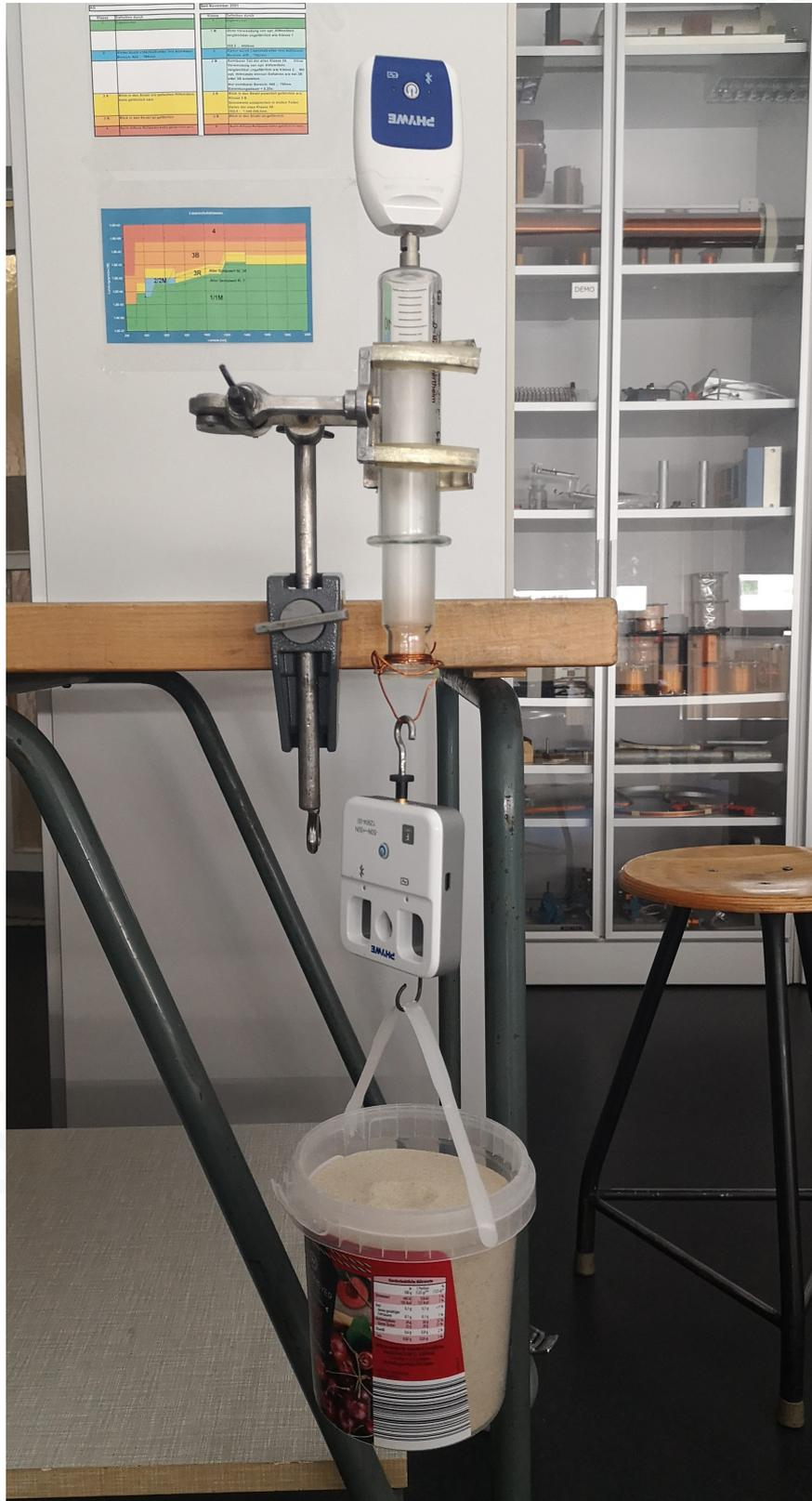
Abb. A.2: Foto des Aufbaus zum Kolbendruck, befestigt an einem Tisch, mit den Sensoren von Phyte.
