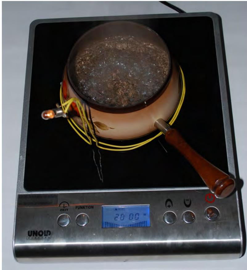
*Abb. 23 Leiterschleife mit leuchtender Glühlampe auf eingeschalteter Induktionskochplatte*
