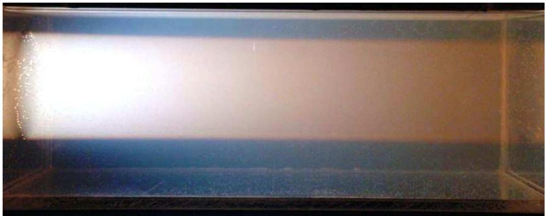
Abbildung 9: Paralleles Strahlenbündel an Latexemulsion gestreut
