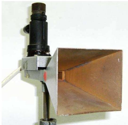
Abbildung 15: Klystron auf dem Wellenleiter im verwendeten Aufbau
