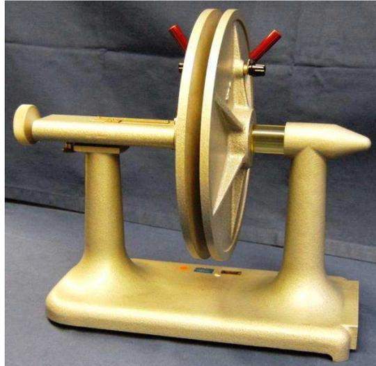
Abbildung 30: Messkondensator mit variablem Plattenabstand
