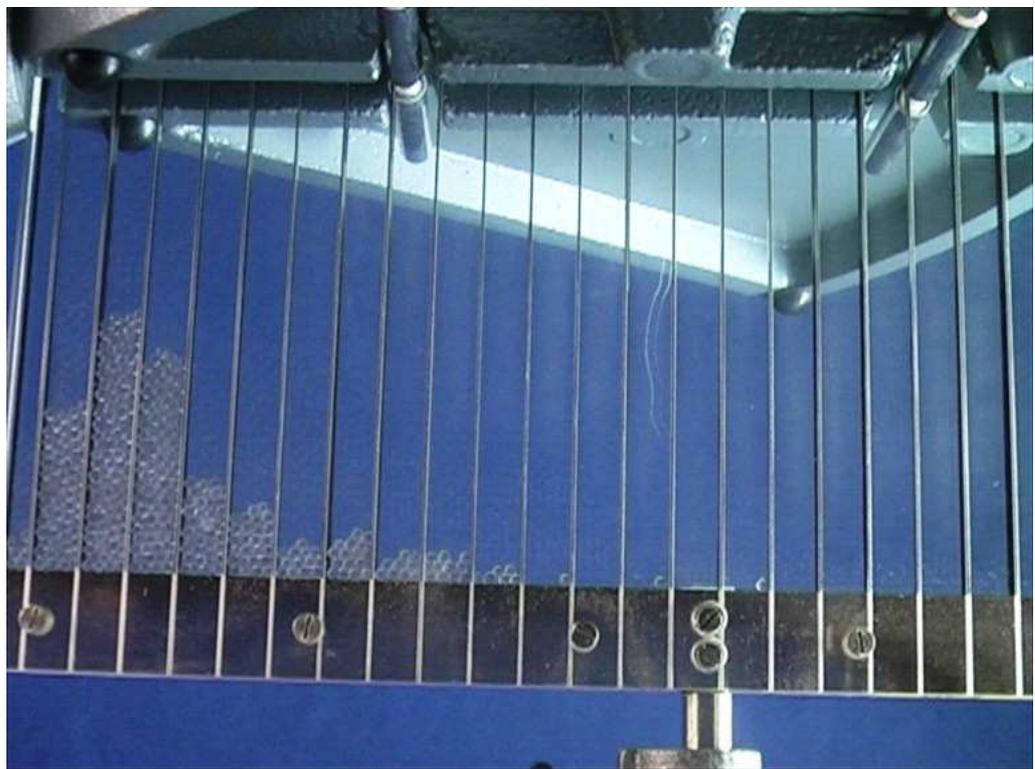
Abbildung 25: Aufnahme der Maxwellschen Geschwindigkeitsverteilung aus Video 6.2
