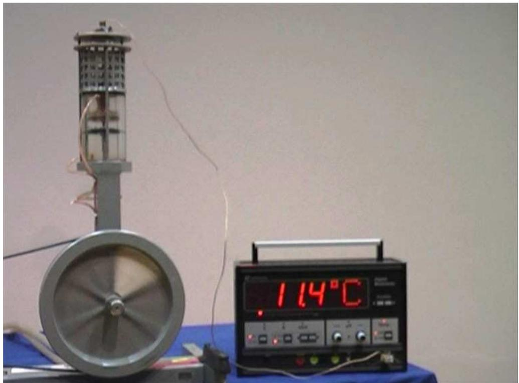
Abbildung 20: Stirlingmotor als Kältemaschine aus Video 5.2
