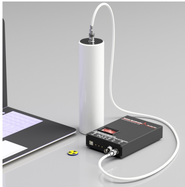
Abbildung 2: CsI(Tl)-Detektor mit PMT in weißem Gehäuse und Elektronikeinheit für die Signalverarbeitung und -weiterleitung [Se21].
