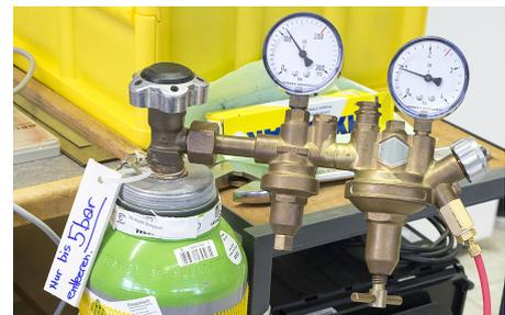
Nun kann die Verbindungsleitung mit der Funkenkammer verbunden werden (Messingschnellkupplung). Beim Einstecken der Verbindung muss das Einrasten durch ein leises Klicken hörbar sein. Mit dem Regelknopf am Omega-Rotameter kann der Durchfluss eingestellt werden. Mit dem Bubbler kann der Durchfluss überwacht werden. Bei einem Wasserstand von 15 mm über dem Einströmrohr und Rotameteranzeige 20 blubbert er etwa alle 30 Sekunden.
