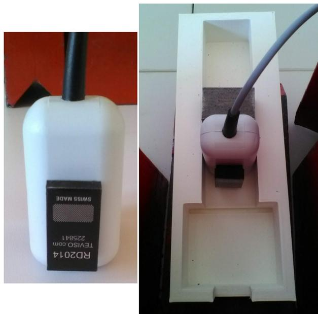
**Abbildung 1:** Links: Der Detektor ist in dem schwarzen Block enthalten, der sich auf der weißen Kunststoffbox befindet. Die sensitive Fläche ist der gräuliche, rechteckige Bereich auf dem schwarzen Block. Rechts: Der Detektor befindet sich in einer Quellenhalterung und kann entlang der Rille frei bewegt werden, um so die Zählraten einzustellen (im Bild noch ohne radioaktive Quelle).
